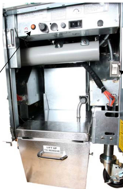
Figuur 4: De geassembleerde smelten unit wordt in positie.
